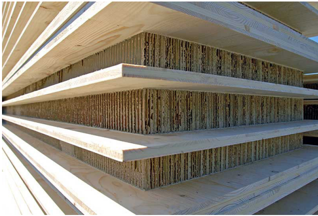
ECOCELL®Baustoff: besteht im Kern aus Recycling-Papier mit einer feinteiliger Wabenstruktur
