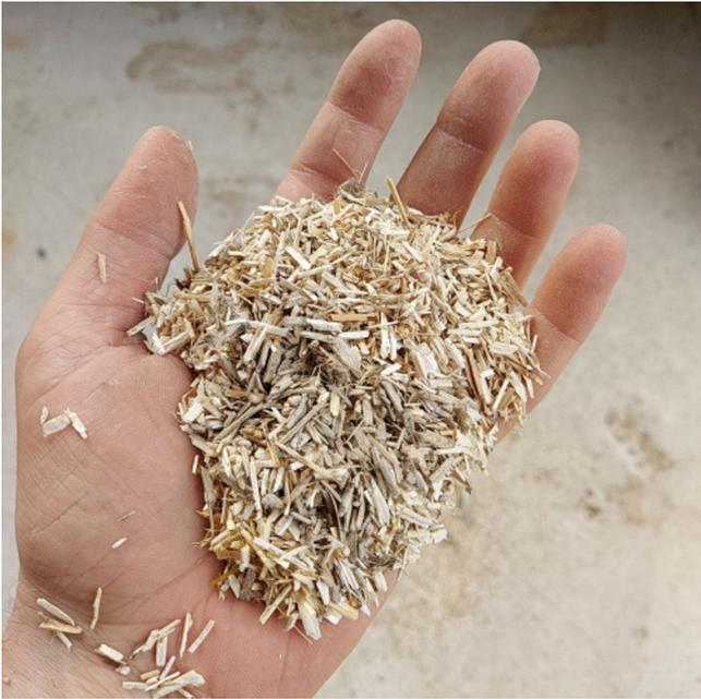
Ein regional herstellbarer, ökologischer Bau- und Dämmstoff bestehend aus 80-90 % Hanfschäben und einem kalkbasierten Bindemittel. Durch den hohen Pflanzenanteil ist Hanfkalk CO<sub>2</sub>-negativ. Hanfkalk verbindet viele Eigenschaften eines enkeltauglichen Baustoffs
